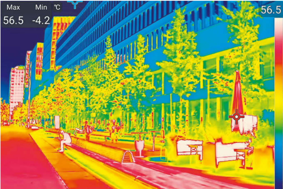
Die Europaallee in Zürich, links mit einer konventionellen Kamera, rechts mit einer Wärmebildkamera fotografiert, am 30. Juli um 9.50 Uhr. Die Wärmebildkamera erfasst kein sichtbares Licht und keine Farben, sondern Infrarotstrahlung (Wärmestrahlung), die von Oberflächen abgestrahlt wird. Blau steht für kalt, rot für heiss, weiss markiert die höchsten Temperaturen.
